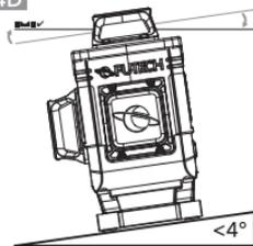
El equipo se autonivela en un rango de aproximadamente 4°. Asegúrese de que el instrumento no se encuentre en una pendiente que supere este límite.
