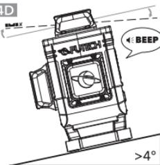
Si la inclinación supera los 4°, las líneas láser parpadearán rápidamente y el láser empezará a pitar.
