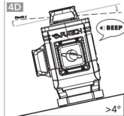
Se la pendenza supera i  $4^\circ$ , le linee laser lampeggiano velocemente e il laser inizia a emettere un segnale acustico.
