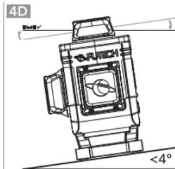
Il dispositivo può autolivellarsi entro un intervallo di circa  $4^\circ$ . Assicurarsi che il dispositivo non sia posizionato su una pendenza superiore a questo limite.
