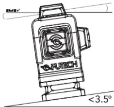
Das Gerät ist in der Lage, sich innerhalb eines Bereichs von etwa 3,5° selbst zu nivellieren. Achten Sie darauf, dass das Gerät nicht auf einer Neigung steht, die diese Grenze überschreitet.
