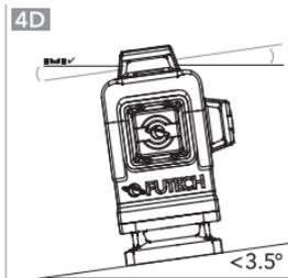
Cet appareil peut se mettre automatiquement de niveau dans une plage d'environ 3.5°. Assurez-vous que l'instrument n'est pas placé sur une pente qui dépasse cette limite.
